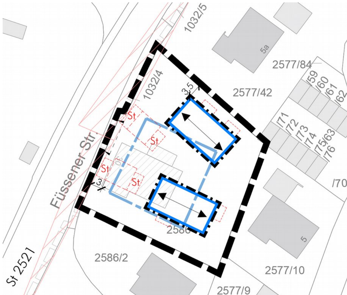
Abbildung 1: Planzeichnungsausschnitt mit Darstellung des alten Baufensters in Hellblau, unmaßstäblich
