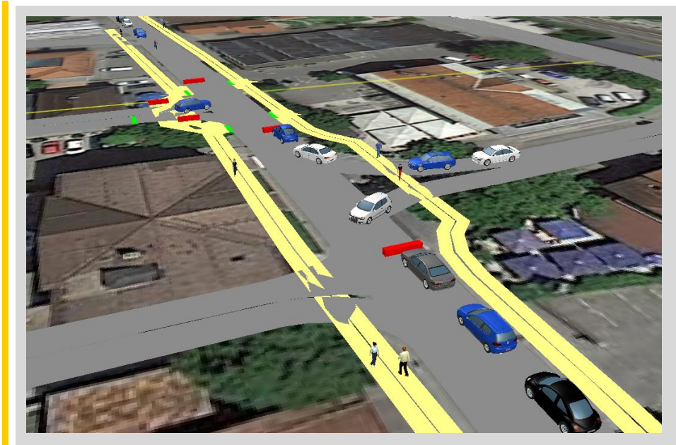
Abbildung 3.3: Implementierung Lichtsignalanlage in der Variante 2
