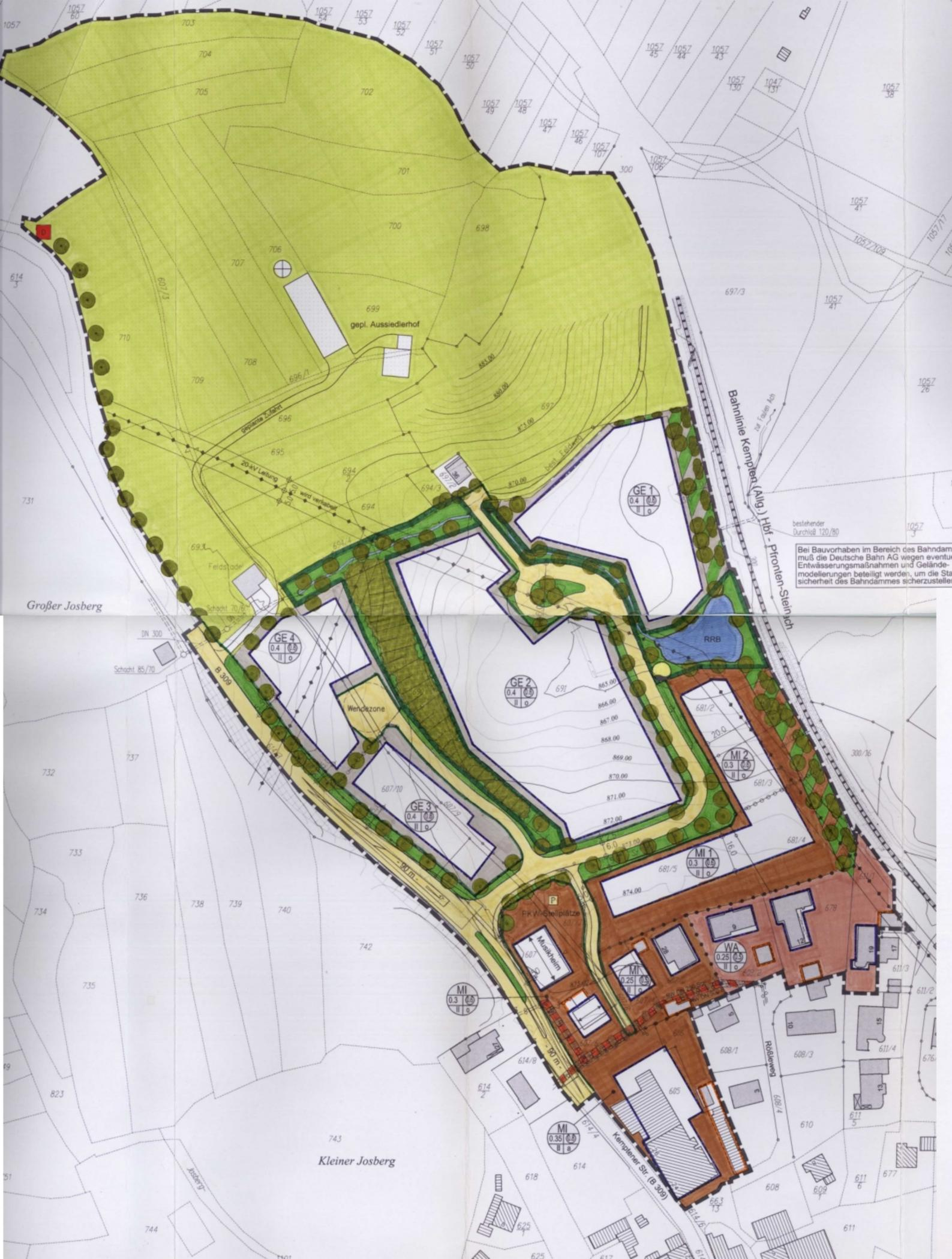
Bei Bauvorhaben im Bereich des Bahndamm muß die Deutsche Bahn AG wegen eventuell Entwässerungsmaßnahmen und Gelände-modellierungen beteiligt werden, um die Standsicherheit des Bahndammes sicherzustellen.
